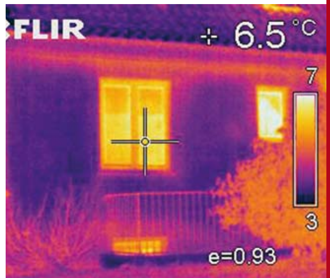
Den blålige farve på facade og tag viser, at disse områder er kolde og dermed godt isolerede. Vinduerne derimod lader megen varme slippe ud og kulde ind.
